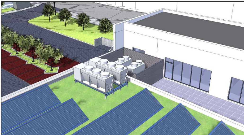
Abbildung 14: vorgesehener Standort der lufttechnischen Anlagen auf dem Dach des Erdgeschosses (Rückkühler) sowie der Terrasse des Obergeschosses (Wärmepumpen) (Die dargestellte Abschirmung der Wärmepumpen ist beispielhaft.) (Quelle: Architekturbüro Wittig [7])
